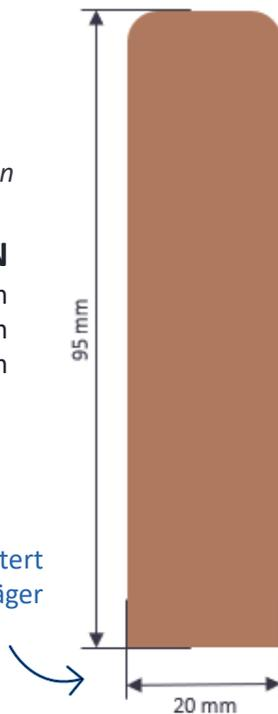
Eine quadratische Seite erleichtert das Einsetzen in den Lamellenträger
